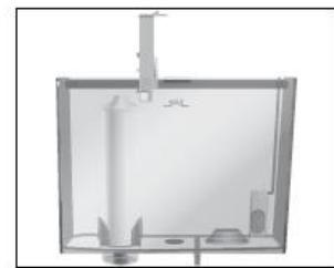
◀ סובבו את כפתור הפעלה המסתובב למצב קיטור **FILTER RINSING**, מים יזרמו מבעד לקפוצ'ינטור. פעולת השטיפה תיפסק אוטומטית לאחר כ- 500 מ"ל. על התצוגה יופיע **SWITCH CLOSE**.
